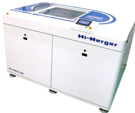
“HM-20000W”は、大型化することにより、シリーズ史上最大容量のペール缶を2缶同時に攪拌するなど、量産ニーズに対応した大容量の攪拌脱泡機です。攪拌脱泡機『ハイマージャ』は、高速で自転と公転をさせることで、容器内で対流をさせ、混ぜる(攪拌)と同時に泡を除去(脱泡)する装置です。プロペラレスのため、材料のダメージとロスを低減します。
